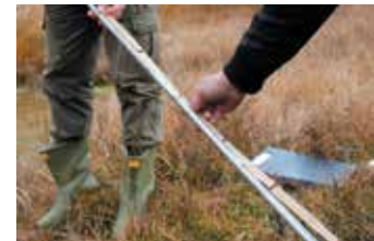
Misurazione della parte di sonda entrata nel terreno.
