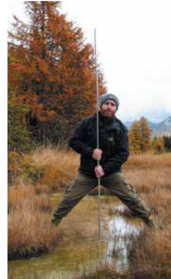
La misurazione della profondità della torba con la sonda metallica.
