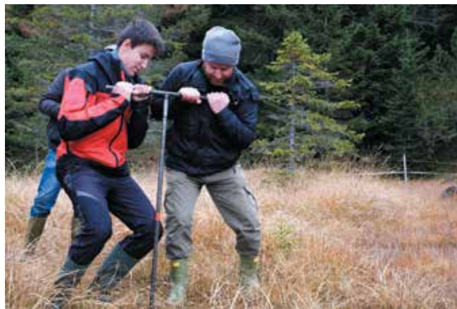
Il carotaggio svolto per l'estrazione di un campione di torba.
